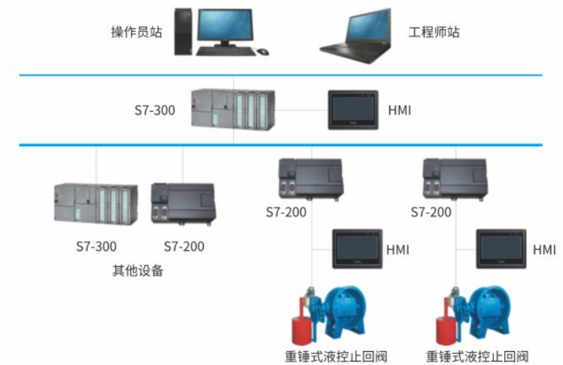
某水电站自动化控制系统部分示图
